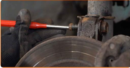
**14** Destornille la fijación superior de la pata amortiguadora. Use un vaso de impacto del n.º 21.
