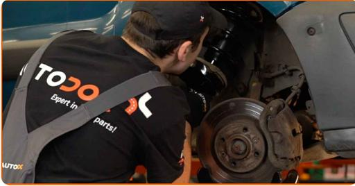
25 Fije la tuerca de fijación superior en la pata amortiguadora. No lo apriete.
