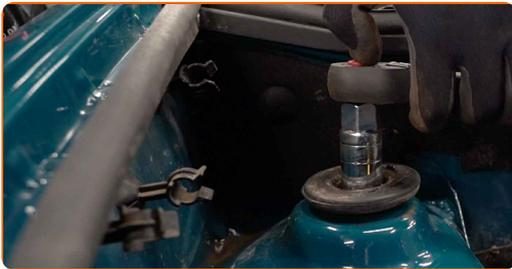
Sustitución: copelas del amortiguador - RENAULT Clio II Hatchback (BB, CB).
