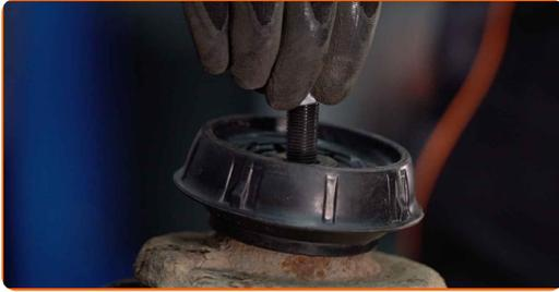
21 Apriete la tuerca de la varilla de la pata amortiguadora. Use Vaso HEX No. H6. Usa una llave mixta del n.º 14. Utilice una llave dinamométrica. Apriételo a un par de 60 Nm.
