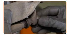
Apriete las sujeciones de la pinza del freno. Usa una llave mixta del n.º 15. Use un vaso de impacto del n.º 13. Utilice una llave dinamométrica. Apriételo a un par de 35 Nm.
