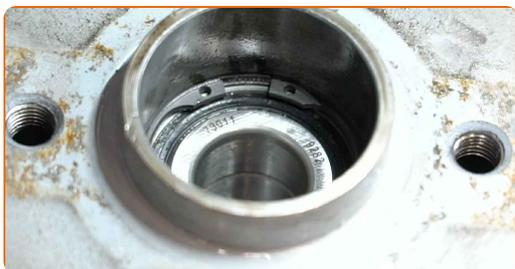
**15** Limpie el asiento de montaje del cojinete del cubo (bujete). Utilice un spray de limpieza multiuso.
