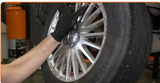
**6** Retire la tapa del cojinete del cubo. Use una palanca. Utilice un martillo.
