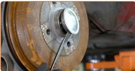
**7** Desenrosque el elemento de sujeción del cubo de rueda. Use un vaso de impacto del n.º 30. Utilice una llave giramachos.
