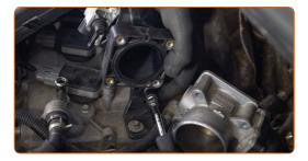
Desconecte la manguera de vacío del reforzador de freno del colector de admisión.
