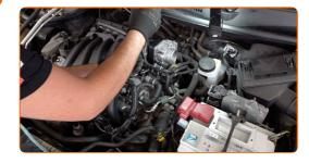
Conecte la manguera de ventilación del cárter al conducto de aire. Use alicates de punta redondeada.
