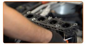
Retire la junta del colector de admisión. Utilice un destornillador plano.
