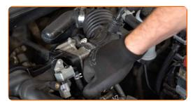
Desatornille las abrazaderas y las sujeciones en el tubo de aspiración del filtro de aire. Use un vaso de impacto del n.º 10. Utilice una llave de trinquete.
