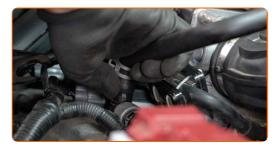
Apriete la abrazadera y las sujeciones en el tubo de entrada del filtro de aire. Use un vaso de impacto del n.º 10. Utilice una llave de trinquete.
