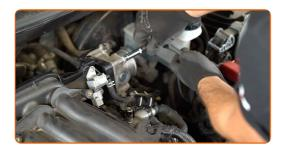
Suelte la abrazadera y separe el conector y la manguera de vacío del colector de admisión cerca de la válvula de mariposa. Use alicates de punta redondeada.
