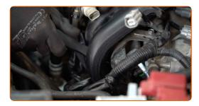
Apriete las sujeciones del soporte del colector de admisión. Use un vaso de impacto del n.º 10. Utilice una llave dinamométrica. Apriételo a un par de 10 Nm.
