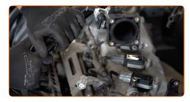
Apriete las sujeciones del colector de admisión. Use un vaso de impacto del n.º 10. Utilice una llave dinamométrica. Apriételo a un par de 27 Nm.
