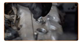
Atornille las buujías nuevas y apriételas. Use el vaso de bujía # 16. Utilice una llave dinamométrica. Apriételo a un par de 19.6 Nm.
