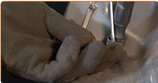
7 Libere el anillo de seguridad que conecta el amortiguador de gas a la puerta del maletero. Utilice un destornillador plano.
