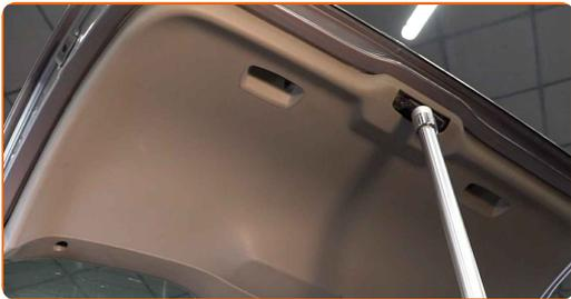
6 Libere el anillo de seguridad que conecta el amortiguador de gas a la carrocería del automóvil. Utilice un destornillador plano.
