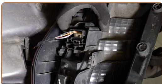
4 Desconecte el conector de las bombillas de los faros traseros. Utilice un destornillador plano.
