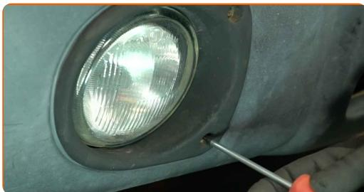
**2** Retire los elementos de sujeción.
