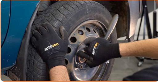
**38** Baje el automóvil y, manteniendo el orden cruzado, apriete los pernos de fijación de las ruedas. Utilice una llave de impacto para llanta # 19. Utilice una llave dinamométrica. Apriételo a un par de 110 Nm.
