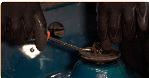
4 Afloje la sujeción superior del soporte del amortiguador. Usa una llave mixta del n.º 21. Use Vaso HEX No. H6. Utilice una llave de trinquete.
