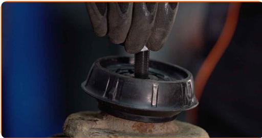
27 Apriete la tuerca de la varilla de la pata amortiguadora. Use Vaso HEX No. H6. Usa una llave mixta del n.º 14. Utilice una llave dinamométrica. Apriételo a un par de 60 Nm.
