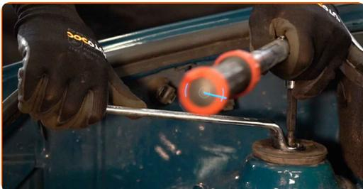
**40** Instale la tapa del soporte del amortiguador.
