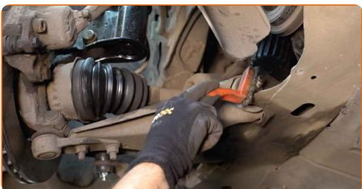
**12** Destornille la fijación delantera de la palanca. Use un vaso de impacto del n.º 18. Utilice una llave giramachos.
