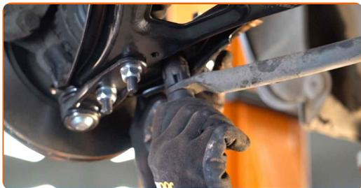
**45** Apriete las fijaciones de la bieleta de la barra estabilizadora. Utilice Torx T40. Use un vaso de impacto del n.º 13. Utilice una llave dinamométrica. Apriételo a un par de 14 Nm.
