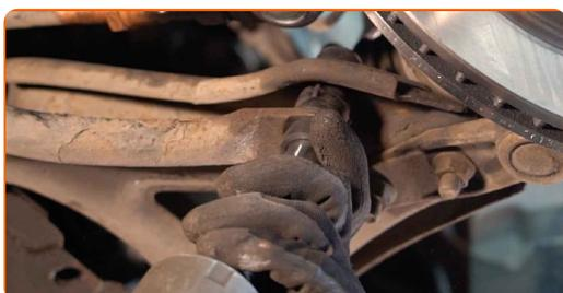
**14** Retire el enlace estabilizador de estabilidad transversal.
