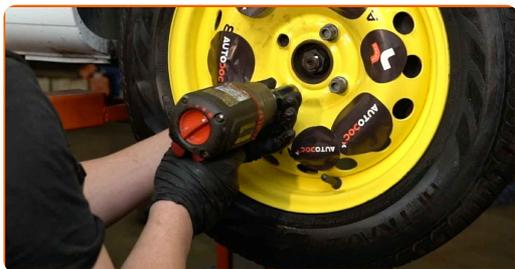
**24** Baje el automóvil y, manteniendo el orden cruzado, apriete los pernos de fijación de las ruedas. Utilice una llave de impacto para llanta # 17. Utilice una llave dinamométrica. Apriételo a un par de 105 Nm.
