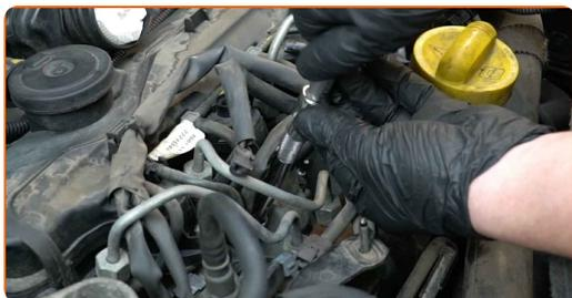
**16** Apriete las bujías de precalentamiento. Use el vaso de bujía # 10. Utilice una llave dinamométrica. Apriételo a un par de 15 Nm.
