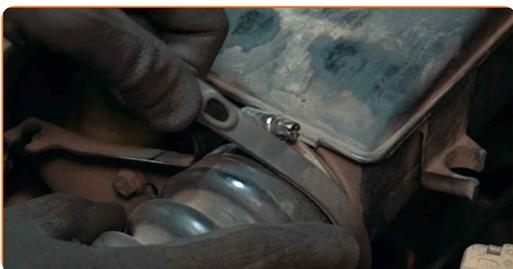
**5** Separe la carcasa del conducto de aire de la carcasa del filtro de aire.
