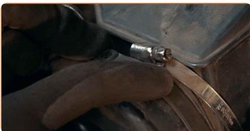
**19** Atornille la abrazadera de sujeción que conecta el conducto de aire a la carcasa del filtro de aire. Use un vaso de impacto del n.º 7. Utilice una llave giramachos.
