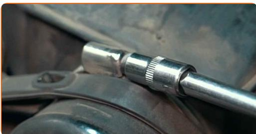
**4** Separe la abrazadera del conducto de aire. Retire la manguera de admisión de aire.
