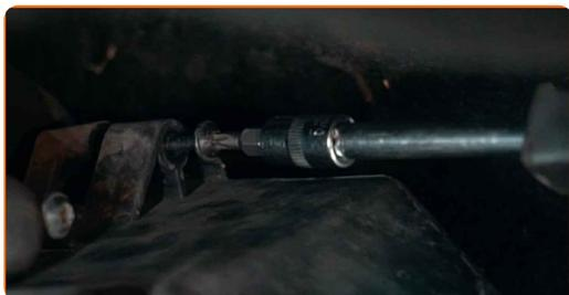
**15** Conecte el conector de la manguera de vacío.
