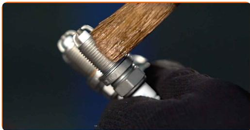
**9** Instale las nuevas bujías en sus asientos de montaje. Use el vaso de bujía # 16.
