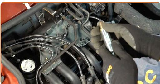
**8** Aplique una capa fina de un lubricante antigripado especial de alta temperatura a las roscas de las nuevas bujías.
