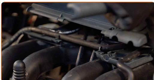
**4** Retire los conectores del cable de bujías de los pozos de la bujía. Use alicates de punta redondeada.
