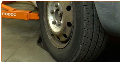
2 Afloje los elementos de fijación de las ruedas. Utilice un vaso de impacto para ruedas de 24 mm. Utilice una llave giramachos con mango en T.
