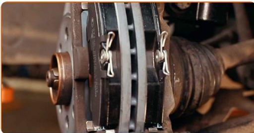
25 Trate el pistón de la pinza de freno. Utilice un cepillo de limpieza de nylon. Use un limpiador de frenos.
