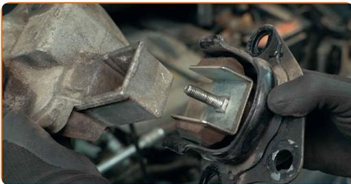
12 Limpie el asiento de montaje del soporte del motor. Use un cepillo de alambre. Use el aerosol WD-40.
