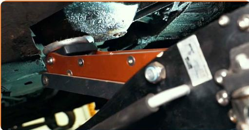
4 Limpie las sujeciones del soporte del motor. Use un cepillo de alambre. Use el aerosol WD-40.
