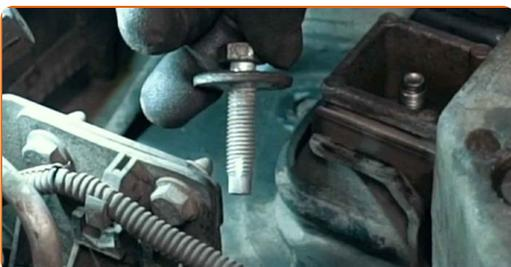
10 Retire el soporte del motor.
