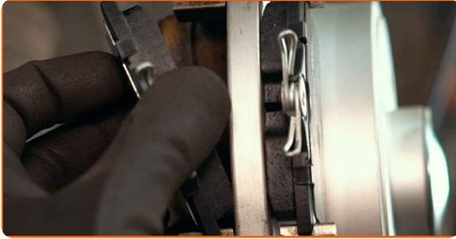
26 Trate el pistón de la pinza de freno. Utilice un cepillo de limpieza de nylon. Use un limpiador de frenos.
