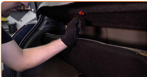
**3** Destornille la fijación superior del amortiguador. Use un vaso de impacto del n.º 16. Utilice una llave de trinquete.
