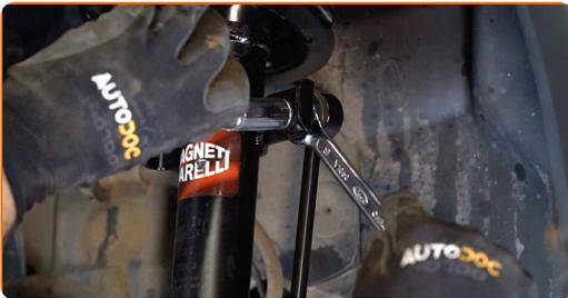
**12** Apriete la sujeción que conecta la bieleta a la barra estabilizadora. Use un vaso de impacto del n.º 14. Usa una llave mixta del n.º 15. Utilice una llave dinamométrica. Apriételo a un par de 44 Nm.
