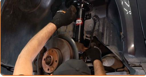
**11** Apriete la sujeción que conecta la bieleta de barra estabilizadora al amortiguador. Use un vaso de impacto del n.º 14. Usa una llave mixta del n.º 15. Utilice una llave dinamométrica. Apriételo a un par de 44 Nm.
