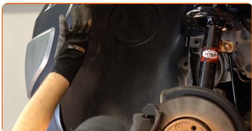
**50** Instale y apriete las sujeciones de la cubierta del paso de rueda. Utilice Torx T20.
