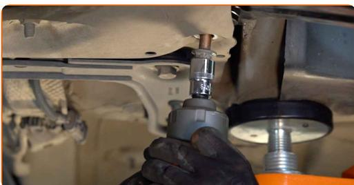
**33** Instale el tornillo de sujeción delantero del brazo. Use una palanca. Utilice un mazo de goma.
