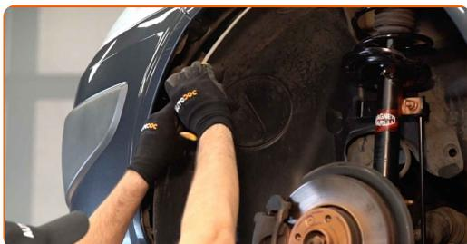
**11** Limpie las sujeciones de la barra de refuerzo del parachoques y de su soporte. Use un cepillo de alambre. Use el aerosol WD-40.
