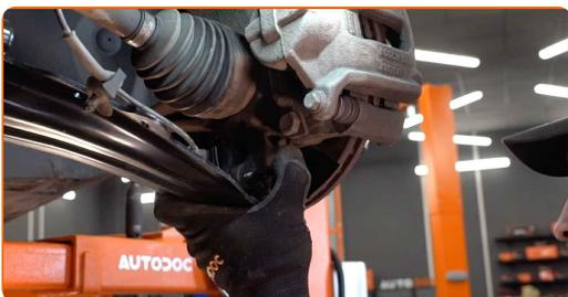
**31** Instale las sujeciones del brazo de control.
