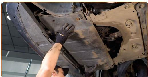
**52** Atornille las sujeciones del aislante acústico inferior. Use un vaso de impacto del n.º 12.
