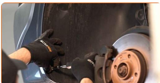
**10** Retire la cubierta del paso de rueda.
