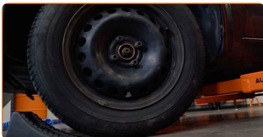
**4** Afloje los pernos de fijación de la rueda. Utilice una llave de impacto para llanta # 19.
