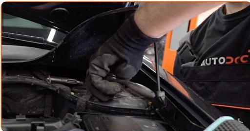
Sustitución: copelas del amortiguador - RENAULT Megane II Hatchback (BM, CM). Los profesionales recomiendan:
