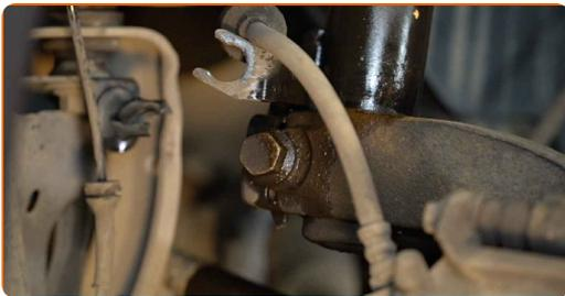
**15** Destornille la fijación inferior de la pata amortiguadora. Use un vaso de impacto del n.º 19. Utilice una llave giramachos.
