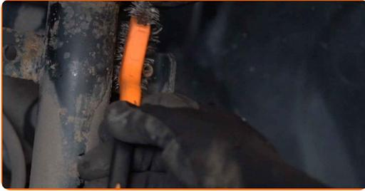
**13** Destornille la tuerca y quite la barra del estabilizador desde la pata amortiguadora. Use Vaso HEX No. H6. Usa una llave mixta del n.º 17.
