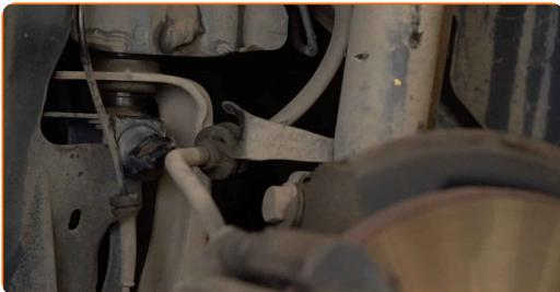
**12** Limpie las sujeciones de la bieleta o enlace estabilizador. Use un cepillo de alambre. Use el aerosol WD-40.
