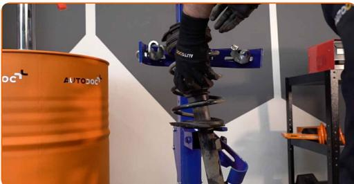
Sustitución: copelas del amortiguador - RENAULT Megane II Hatchback (BM, CM). Consejo de los expertos de AUTODOC:
