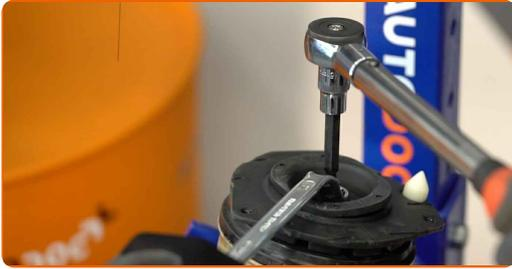
Sustitución: copelas del amortiguador - RENAULT Megane II Hatchback (BM, CM). Consejo de AUTODOC:
