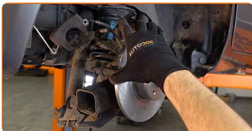
**27** Apriete la fijación de la pinza del cáliper de freno. Use un vaso de impacto del n.º E16. Utilice una llave dinamométrica. Apriételo a un par de 105 Nm.
