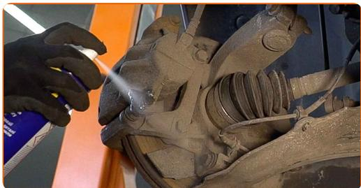
**8** Destornille la fijación del cáliper de freno. Use un vaso de impacto del n.º 13. Utilice una llave de trinquete.
