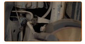
Limpie las sujeciones de la bieleta o enlace estabilizador. Use un cepillo de alambre. Use el aerosol WD-40.
