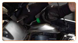
Levante un poco la tapa del soporte del amortiguador. Trate las sujeciones del soporte del amortiguador. Use el aerosol WD-40.
