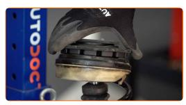
Apriete la tuerca de la varilla de la pata amortiguadora. Use Vaso HEX No. H6. Usa una llave mixta del n.º 18. Utilice una llave dinamométrica. Apriételo a un par de 62 Nm.
