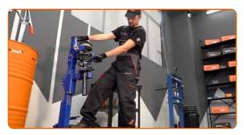
Retire el puntal amortiguador que está montado.
