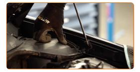
Instale los retenedores de la tapa del soporte del amortiguador.
