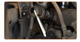
16 Retire el perno de sujeción.
