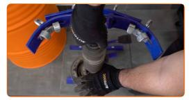
Retire el amortiguador viejo del compresor de muelles hidráulico.
