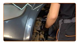
Fije las sujeciones superiores del puntal amortiguador (3 piezas). No lo apriete.
