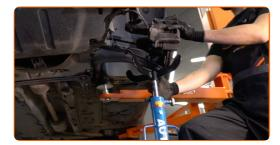
Instale y apriete un nuevo perno de la mangueta de dirección. Use un vaso de impacto del n.º 19. Usa una llave mixta del n.º 19. Utilice una llave dinamométrica. Apriételo a un par de 105 Nm.
