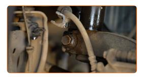
Destornille la fijación inferior de la pata amortiguadora. Use un vaso de impacto del n.º 19. Utilice una llave giramachos.
