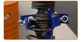
Destornille la tuerca de la varilla de la pata amortiguadora. Use Vaso HEX No. H6. Usa una llave mixta del n.º 18. Utilice una llave de trinquete.
