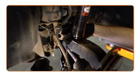
Fije el enlace estabilizador de el soporte de amortiguador. Use Vaso HEX No. H6. Usa una llave mixta del n.º 17. Utilice una llave dinamométrica. Apriételo a un par de 44 Nm.
