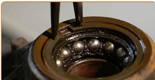
**42** Limpie el asiento de montaje del cojinete del cubo (buje). Use un cepillo de alambre. Use el aerosol WD-40.
