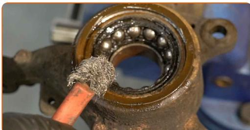
**43** Suelte el tornillo de banco y extraiga el cubo de rueda junto con el rodamiento.
