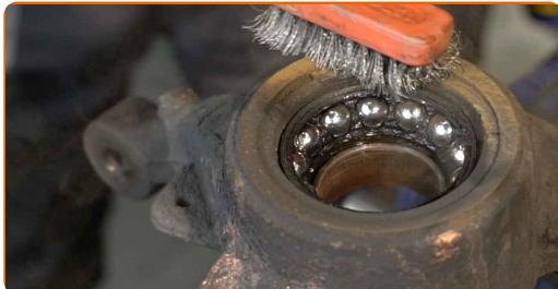
**41** Retire el anillo de retención del cojinete del cubo de rueda. Utilice alicates para arandelas. Utilice un destornillador plano.
