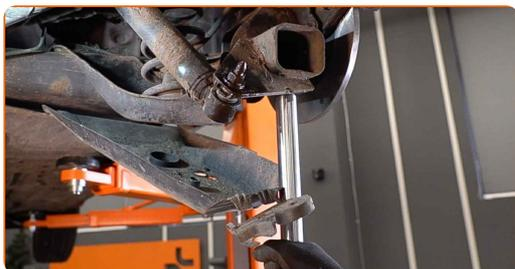
**12** Destornille la fijación inferior del amortiguador. Use un vaso de impacto del n.º 18. Utilice una llave giramachos.
