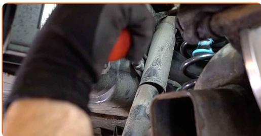
**15** Limpie los asientos de montaje del amortiguador. Use un cepillo de alambre. Use el aerosol WD-40.
