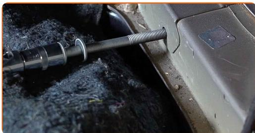
**14** Saque el amortiguador. Use una palanca.
