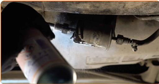
7 Apriete los clips y separe las líneas de suministro de combustible de la carcasa del filtro de aceite. Utilice alicates para conectores de tubos de combustible.
