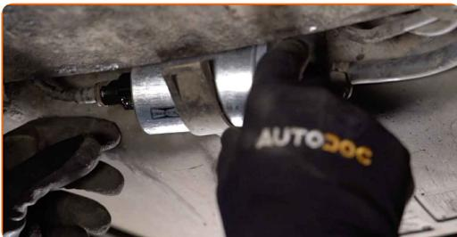
**11** Apriete la fijación del filtro de combustible. Utilice un destornillador Phillips.
