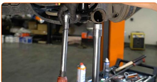
**20** Trate las sujeciones del amortiguador. Use grasa de cobre.
