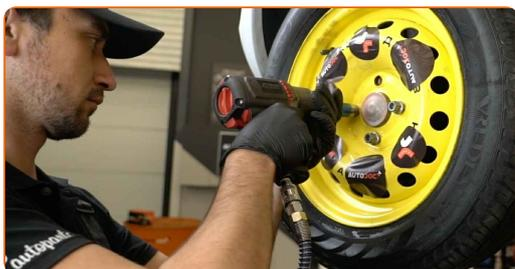
**28** Baje el automóvil y, manteniendo el orden cruzado, apriete los pernos de fijación de las ruedas. Utilice una llave de impacto para llanta # 17. Utilice una llave dinamométrica. Apriételo a un par de 105 Nm.
