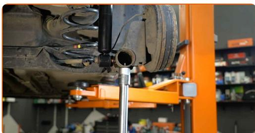
**19** Apriete la fijación inferior del amortiguador. Use un vaso de impacto del n.º 18. Utilice una llave dinamométrica. Apriételo a un par de 105 Nm.
