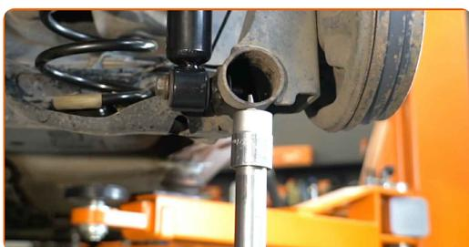
**26** Instale el perno de sujeción.
