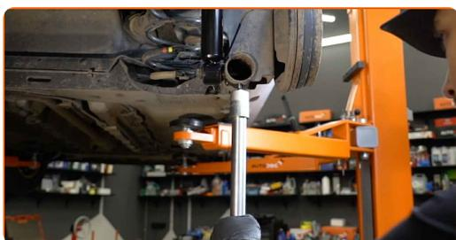
**9** Destornille la fijación inferior del amortizador. Use un vaso de impacto del n.º 18. Utilice una llave de trinquete.
