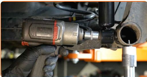
**10** Retire el perno de sujeción.
