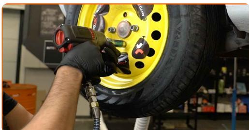
**35** Baje el automóvil y, manteniendo el orden cruzado, apriete los pernos de fijación de las ruedas. Utilice una llave de impacto para llanta # 17. Utilice una llave dinamométrica. Apriételo a un par de 105 Nm.
