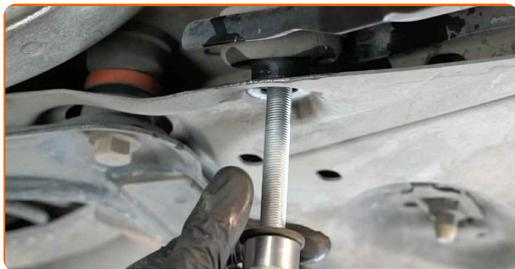
**15** Desatornille la sujeción trasera que conecta el brazo de control al subchasis. Use una llave mixta del n.º 18. Use un vaso de impacto del n.º 18. Utilice una llave giramachos.
