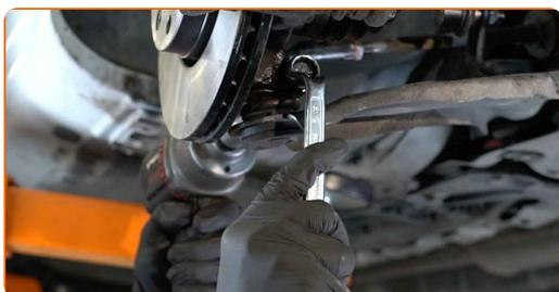
**14** Retire el perno de sujeción.
