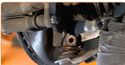
**20** Desconecte el soporte esférico del muñón de dirección.
