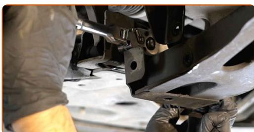
**16** Retire la sujeción trasera del brazo de control.
