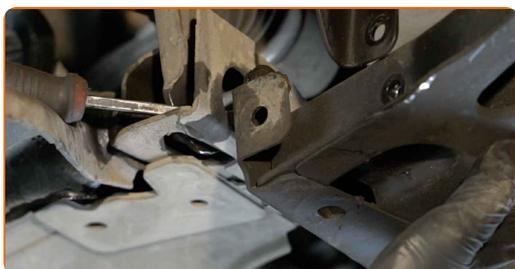
**17** Destornille la fijación delantera de la palanca. Use una llave mixta del n.º 18. Use un vaso de impacto del n.º E16. Utilice una llave giramachos.
