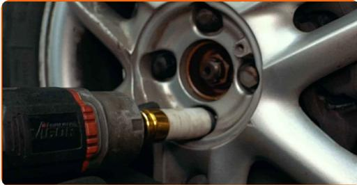
58 Baje el automóvil y, manteniendo el orden cruzado, apriete los pernos de fijación de las ruedas. Utilice una llave de impacto para llanta # 19. Utilice una llave dinamométrica. Apriételo a un par de 90 Nm.
