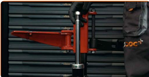
**35** Instale el guardapolvo y el tope en el amortiguador nuevo.
