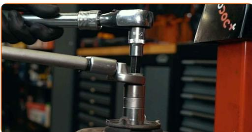
40 Trate la varilla del amortiguador. Use grasa de cobre.
