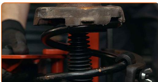
42 Retire el puntal amortiguador que está montado.
