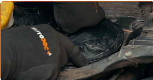
63 Instale los retenedores de la tapa del soporte del amortiguador.
