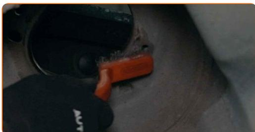
44 Instale la pata amortiguadora en el arco de la rueda.
