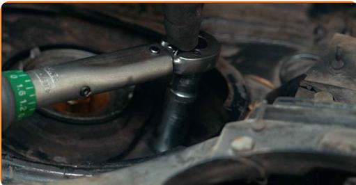
61 Trate las sujeciones del soporte del amortiguador. Use grasa de cobre.
