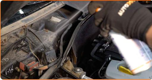
7 Desatornille las sujeciones de la cubierta de la carcasa del filtro de habitáculo. Utilice un destornillador Phillips.
