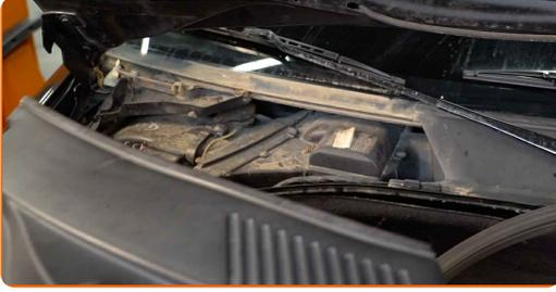
6 Limpie la carcasa y la cubierta del filtro de cabina. Utilice un spray de limpieza multiuso.
