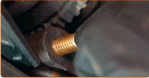
22 Atornille la sujeción que conecta la rótula a la mangueta de dirección. Use una llave mixta del n.º 16. Use un vaso de impacto del n.º 16. Utilice una llave de trinquete.
