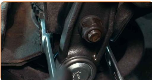
23 Apriete la fijación de la pinza del cáliper de freno. Use un vaso de impacto del n.º 18. Utilice una llave dinamométrica. Apriételo a un par de 100 Nm.
