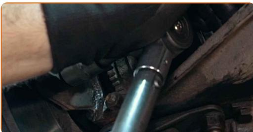
24 Apriete las sujeciones que conectan la rótula al brazo de control. Use un vaso de impacto del n.º 18. Utilice una llave dinamométrica. Apriételo a un par de 75 Nm.
