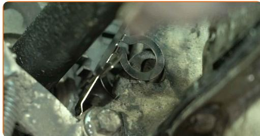
9 Presione sobre el muelle de retención del sensor de posición del cigüeñal. Utilice una palanca de montaje.
