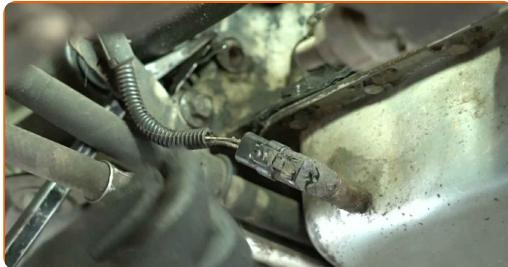
**4** Retire el muelle de retención del sensor de posición del cigüeñal.
