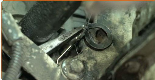
10 Instale el nuevo sensor de posición del cigüeñal.
