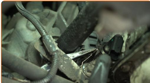
11 Una el conector del sensor de posición del cigüeñal.
