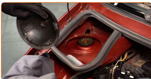
**4** Limpie las sujeciones del soporte superior del puntal amortiguador. Use un cepillo de alambre. Use el aerosol WD-40.
