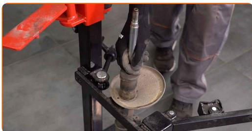
**Sustitución: amortiguador telescópico - RENAULT Twingo I Furgón. Consejo de AUTODOC:**
