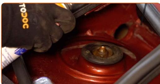
**51** Instale la tapa del soporte del amortiguador.
