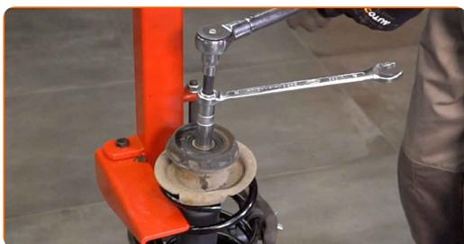
**Sustitución: amortiguador telescópico - RENAULT Twingo I Furgón. Consejo de los expertos de AUTODOC:**
