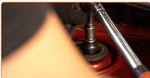
**50** Trate las sujeciones del soporte del amortiguador. Use grasa de cobre.
