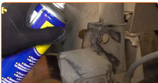
**12** Desatornille la sujeción inferior que conecta el puntal amortiguador a la mangueta de dirección. Usa una llave mixta del n.º 18. Use un vaso de impacto del n.º 18. Utilice una llave giramachos.
