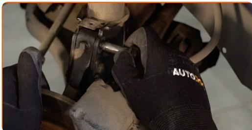
**15** Desconecte el muñón de dirección de la pata amortiguadora. Use una palanca.
