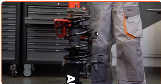
**34** Retire el puntal amortiguador que está montado.
