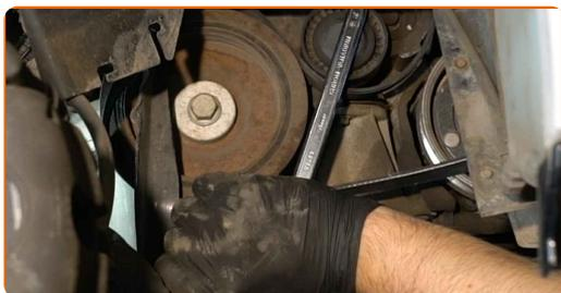
**18** Coloque la correa acanalada en V en la polea tensora.
