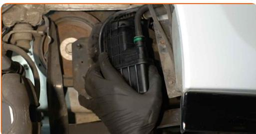
**21** Atornille los bulones de fijación del soporte del filtro de combustible. Usa una llave mixta del n.º 10.
