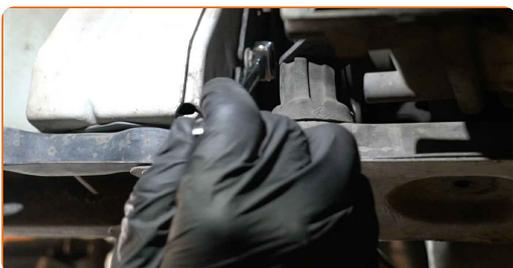
**22** Instale el soporte de fijación del filtro de combustible.
