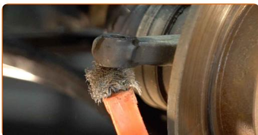
**17** Conecte la punta de la barra de dirección al muñón de dirección.
