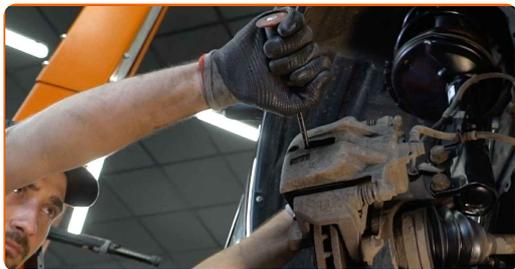
**13** Limpie las sujeciones de la pinza del freno. Use un cepillo de alambre. Use el aerosol WD-40.
