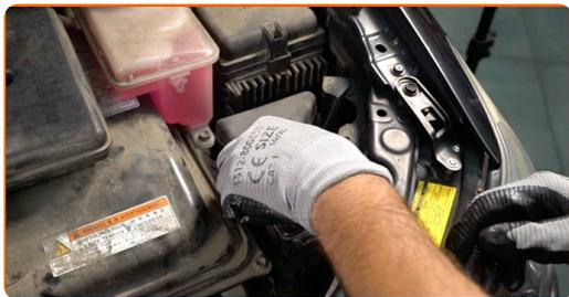
**32** Instale la cubierta del motor.
