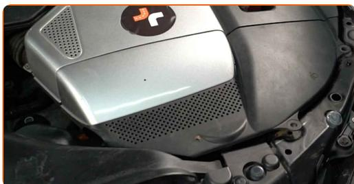
**34** Vuelva a instalar los clips pop de la cubierta protectora.
