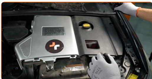
**33** Instale la cubierta de protección.
