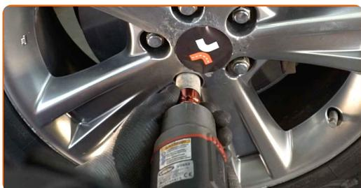
**27** Baje el automóvil y, manteniendo el orden cruzado, apriete los pernos de fijación de las ruedas. Utilice una llave de impacto para llanta # 21. Utilice una llave dinamométrica. Apriételo a un par de 103 Nm.
