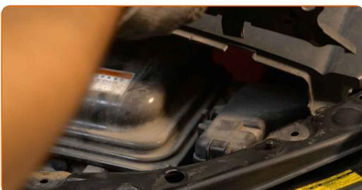
**4** Retire la cubierta del motor. Utilice un destornillador plano.
