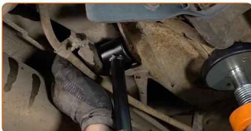
Sustitución: brazo tirado inferior de la suspensión trasera - Lexus RX XU30.
