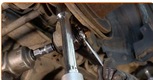
**18** Apriete la sujeción que conecta el brazo de arrastre a la carrocería del automóvil. Usa una llave mixta del n.º 17. Use un vaso de impacto del n.º 17. Utilice una llave giramachos.
