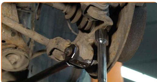
**17** Atornille la sujeción que conecta el brazo de control con la mangueta de dirección trasera. Usa una llave mixta del n.º 18. Use un vaso de impacto del n.º E18. Utilice una llave giramachos.
