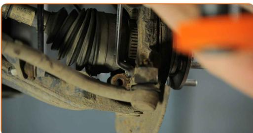
**26.2** Usa una llave mixta del n.º 14. Use un vaso de impacto del n.º 14. Utilice una llave dinamométrica. Apriételo a un par de 50 Nm.
