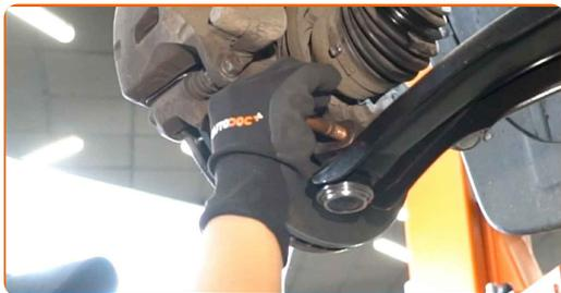
**29** Atornille la sujeción que conecta la rótula a la mangueta de dirección. Use una llave mixta del n.º 19. Use un vaso de impacto del n.º 18. Utilice una llave de trinquete.
