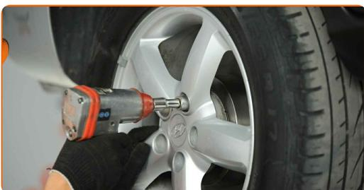
**28** Baje el automóvil y, manteniendo el orden cruzado, apriete los pernos de fijación de las ruedas. Utilice una llave de impacto para llanta # 21. Utilice una llave dinamométrica. Apriételo a un par de 108 Nm.
