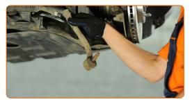
Limpie los asientos de montaje del extremo de la barra de acoplamiento. Use un cepillo de alambre. Use el aerosol WD-40.
