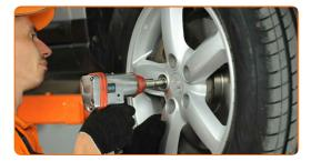
Baje el automóvil y, manteniendo el orden cruzado, apriete los pernos de fijación de las ruedas. Utilice una llave de impacto para llanta # 21. Utilice una llave dinamométrica. Apriételo a un par de 108 Nm.
