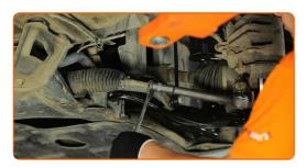
Trate la sujeción que conecta el extremo de la barra de acoplamiento a la mangueta de dirección. Use grasa de cobre.
