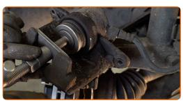
Establezcan el soporte de freno y lo fijen. Use un vaso de impacto del n.º 13. Utilice una llave dinamométrica. Apriételo a un par de 32 Nm.
