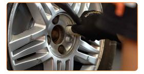
Baje el automóvil y, manteniendo el orden cruzado, apriete los pernos de fijación de las ruedas. Utilice una llave dinamométrica. Apriételo a un par de 110 Nm.
