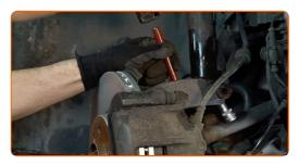
Destornille la fijación superior de la cazoleta de la pata amortiguadora. Use un vaso de impacto del n.º 13. Utilice una llave de trinquete.
