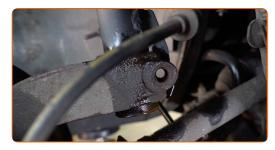
Trate las sujeciones del amortiguador. Use el aerosol WD-40.
