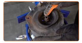
Destornille la tuerca de la varilla de la pata amortiguadora. Usa una llave mixta del n.º 19. Use Vaso HEX No. H6.
