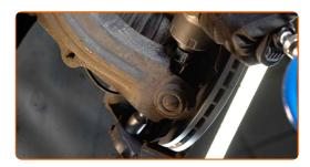
Retire el perno de sujeción.
