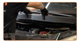
Desatornille la sujeción de la rejilla de la capucha del limpiaparabrisas situada en el lado derecho. Utilice Torx T20.
