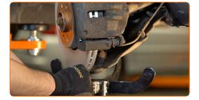
Suelte la sujeción inferior que conecta el puntal amortiguador a la mangueta de dirección. Utilice un vaso de impacto especial para extraer el amortiguador. Utilice una llave de trinquete.
