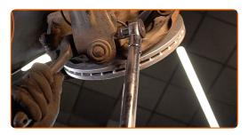
Apriete las sujeciones inferiores que conectan el amortiguador con la mangueta de dirección. Use un vaso de impacto del n.º 18. Utilice una llave dinamométrica. Apriételo a un par de 105 Nm.
