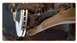
Desconecte el soporte esférico del muñón de dirección. Use una palanca.
