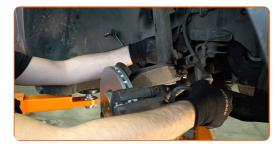
Desatornille la sujeción inferior que conecta el puntal amortiguador a la mangueta de dirección. Use un vaso de impacto del n.º 18. Utilice una llave giramachos.
