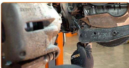
**33** Instale la barra de refuerzo del parachoques. Use una palanca.
