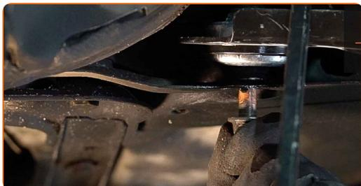
**39** Atornille la fijación trasera de la palanca. Usa una llave mixta del n.º 18. Use un vaso de impacto del n.º 18.
