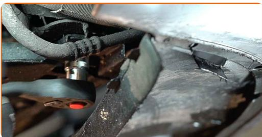
**48** Atornille la sujeción del soporte de la barra de refuerzo del parachoques. Use un vaso de impacto del n.º 13.
