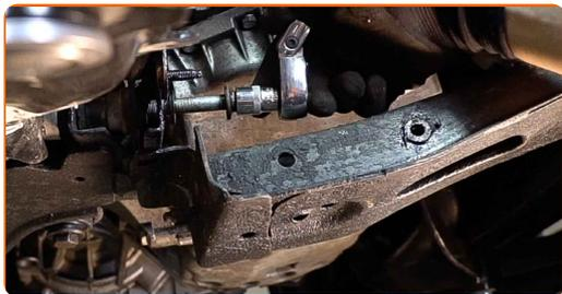
**32** Atornille la fijación delantera de la palanca. Use una llave mixta del n.º 18. Use un vaso de impacto del n.º E16. Utilice una llave de trinquete.
