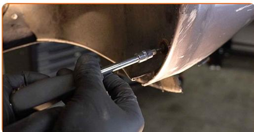
**51** Instale y apriete las sujeciones de la cubierta del paso de rueda. Utilice Torx T20.
