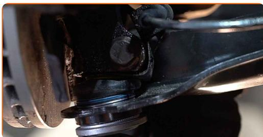
**38** Instale la sujeción trasera del brazo de control.
