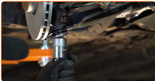
**37** Instale el perno de sujeción. Usa una llave mixta del n.º 16. Use un vaso de impacto del n.º 16.
