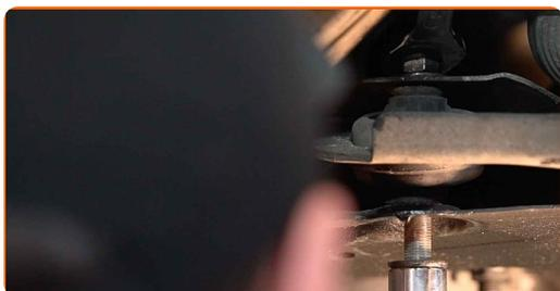
**27** Retire el perno de sujeción.
