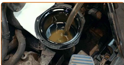
**9** Limpie la carcasa del filtro de combustible y la cubierta.
