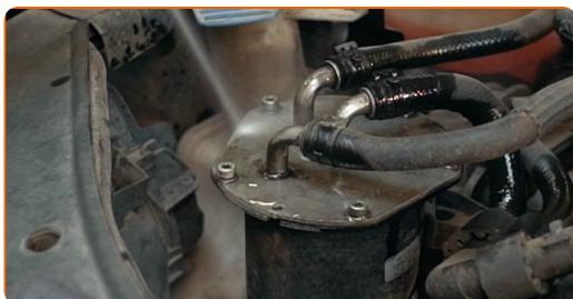
4 Desatornille las sujeciones de la tapa de la carcasa del filtro de combustible. Utilice Torx T15. Utilice una llave de trinquete.
