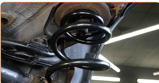
**19** Apoye la mangueta trasera. Utilice un gato de transmisión hidráulica.
