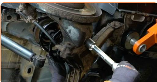
**20** Limpie los asientos de montaje de la barra estabilizadora. Use un cepillo de alambre. Use el aerosol WD-40.
