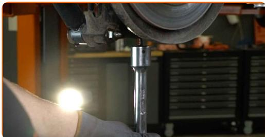
**8** Destornille la fijación inferior del amortizador. Usa una llave mixta del n.º 21. Use un vaso de impacto del n.º 21. Utilice una llave de trinquete.
