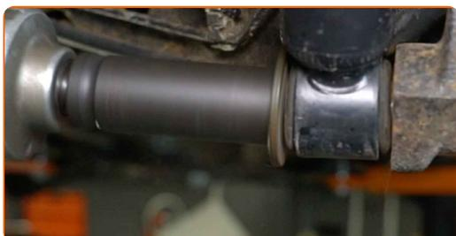
**9** Retire el perno de sujeción.
