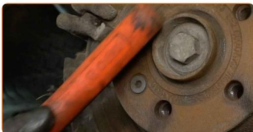
**28** Trate la superficie donde el disco del freno entra en contacto con la llanta de la rueda. Utilice grasa cerámica.
