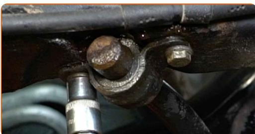
**23** Instale el perno de sujeción.
