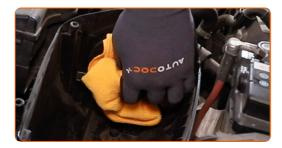
8 Limpie la cubierta y la carcasa del filtro de aire.
