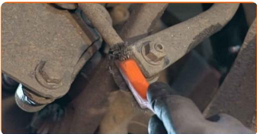
**9** Desatornille la sujeción que conecta la bieleta a la barra estabilizadora. Usa una llave mixta del n.º 16. Utilice las puntas XZN #6. Utilice una llave de trinquete.
