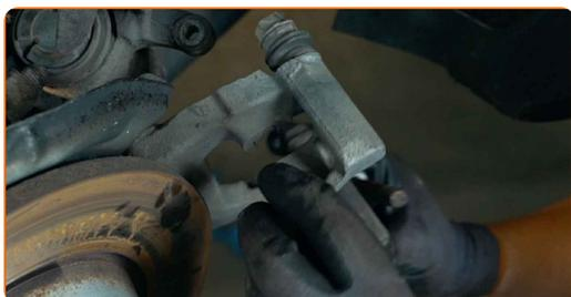
**20** Limpie la sujeción del disco de freno. Use un cepillo de alambre. Use el aerosol WD-40.
