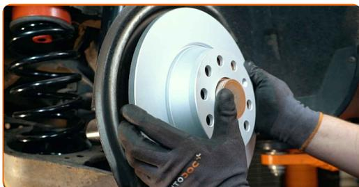
**26** Apriete la fijación del disco de freno. Utilice Torx T30. Utilice una llave dinamométrica. Apriételo a un par de 4 Nm.
