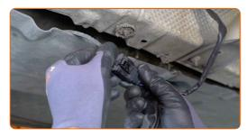
Conecte el cableado del sensor de oxígeno.
