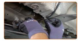
Vuelva a instalar la cubierta inferior del cárter de aceite.
