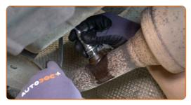
Apriete la sujeción del sensor de oxígeno. Utilice una llave de tuerca abocinada #22. Utilice una llave dinamométrica. Apriételo a un par de 37 Nm.
