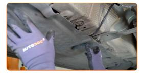
Apriete los sujetadores de la cubierta inferior del cárter de aceite. Use un vaso de impacto del n.º 10. Utilice una llave de trinquete.
