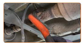
Desenrosque la sujeción del sensor de oxígeno. Utilice una llave de tuerca abocinada #22.
