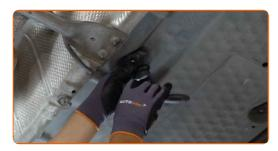
Retire la cubierta del cárter de aceite.
