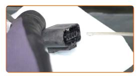
Una el conector del sensor de oxígeno.
